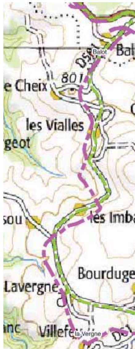
FIG. 37a e 37b. Sulla dipartimentale D581, tra i villaggi di Balot e Lavergne. In Cassini, il centro di Balot si trova a 231 m. sud-ovest rispetto al centro misurato dall'IGN; Le Chier, in Cassini, è a 432 m. nord ovest dal punto di misura IGN in Cassini, indicato come Le Cheix; La Vergne si trova a 627 m. sud-ovest da Lavergne.
