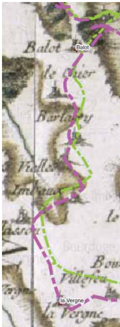
FIG. 37a e 37b. Sulla dipartimentale D581, tra i villaggi di Balot e Lavergne. In Cassini, il centro di Balot si trova a 231 m. sud-ovest rispetto al centro misurato dall'IGN; Le Chier, in Cassini, è a 432 m. nord ovest dal punto di misura IGN in Cassini, indicato come Le Cheix; La Vergne si trova a 627 m. sud-ovest da Lavergne.
